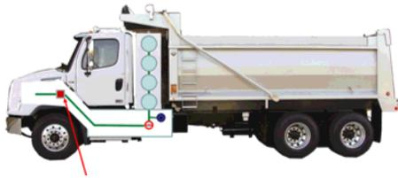
5. El gas entra al regulador, el cual reduce la presión de almacenamiento de hasta 3600 psi hasta la requerida por el sistema de presión de inyección de combustible del vehículo
