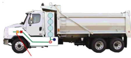
6. La válvula solenoides del gas natural permite el paso del gas desde el regulador hasta el mezclador de gases o inyector de combustible. La válvula solenoides se cierra cuando la máquina está apagada
