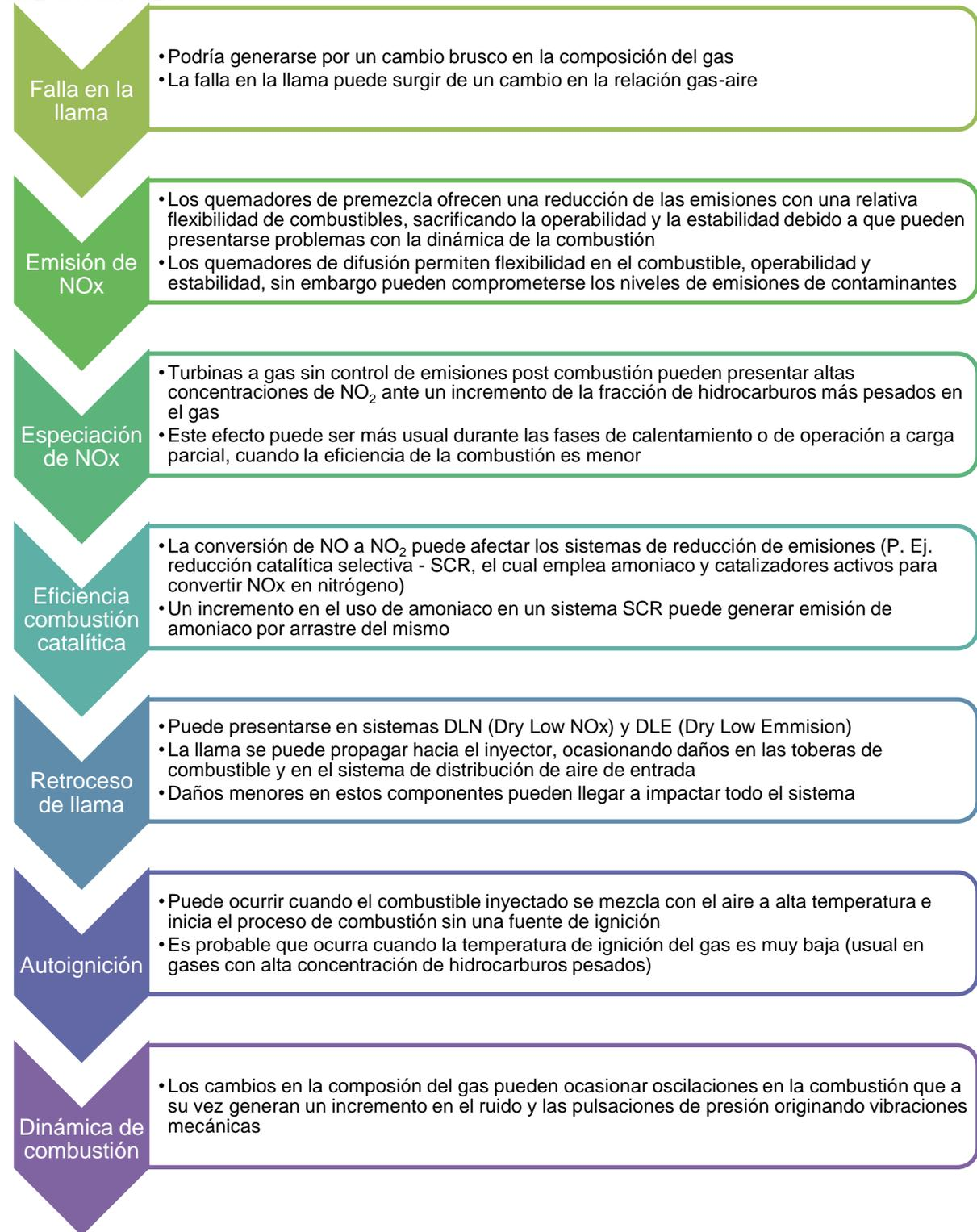
**Figura 5.** Descripción de problemas por intercambiabilidad en turbinas a gas
