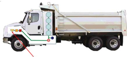
7. La mezcla de gas natural con aire fluye hacia el carburador o sistema de inyección de combustible y entra en la cámara de combustión del motor en donde se quema para producir energía.
